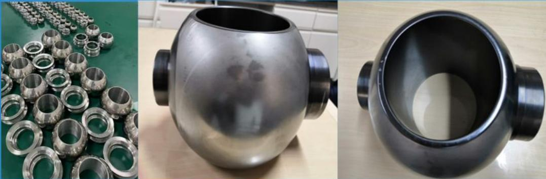
在复杂生产工况下，要求解决球阀耐磨、延长使用寿命、减少执行机构扭矩力的问题。耐磨试验已通过（通过抛光的方法），超出厂家预期。
